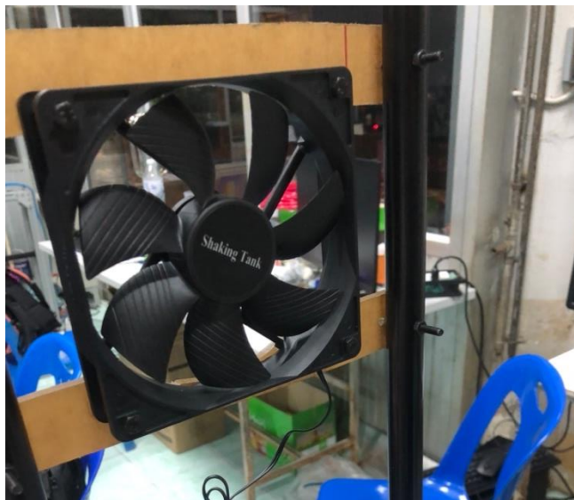
ภาพที่ 3-19 พัดลมระบายอากาศขนาด 8 นิ้ว
