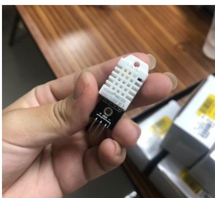
ภาพที่ 3-18 เซนเซอร์ DHT 22 แสดงการใช้วัดค่าความชื้นและอุณหภูมิ
