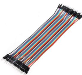
รูปที่ 2.6 สายไฟจัมพ์เปอร์
