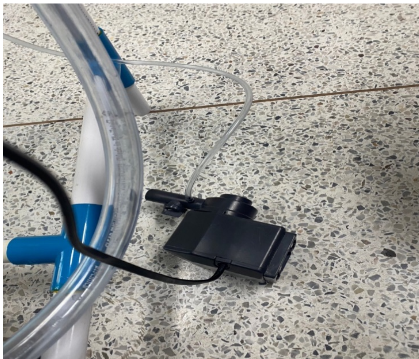
รูปที่ 4.5 ติดตั้ง ปั้มน้ำสำหรับที่พ่นน้ำ
