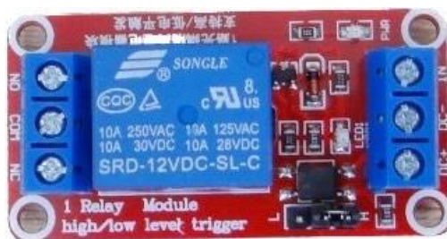
รูปที่ ๗.7 Relay module
